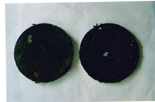
写真2：減容化されたダストの状態 (直径250mm, 厚さ8mmにプレスで圧縮したもの)
