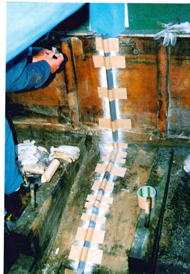
写真1：試作した爆薬の船体への装着
