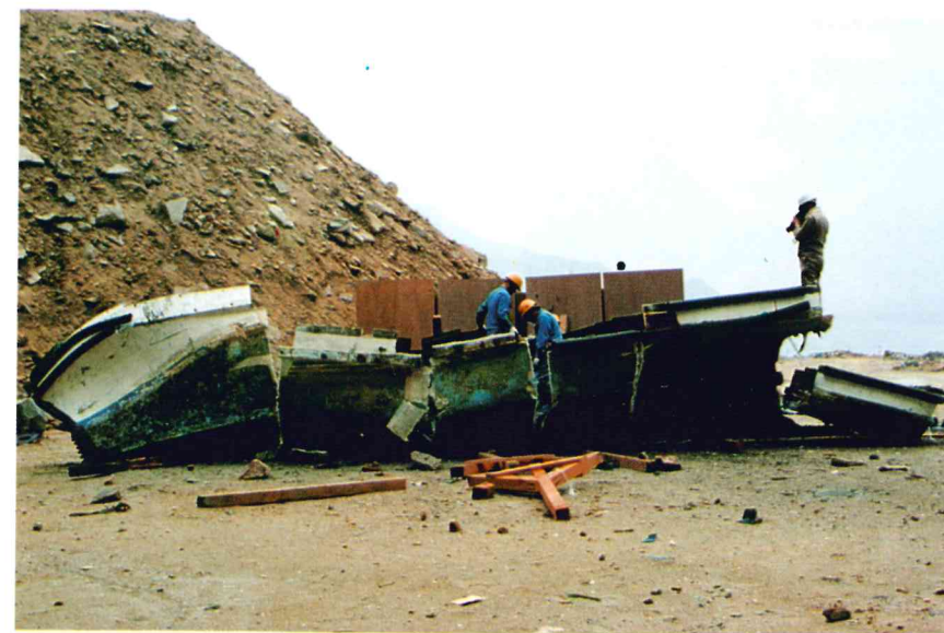
写真2：5等分に爆破、切断されたF R P廃船
