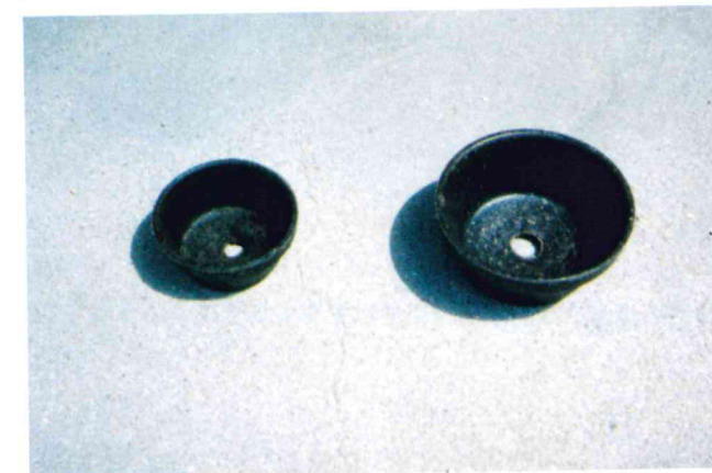
写真3：ダストを利用して試作した植木鉢 (大が直径125mm, 小が90mm)
