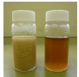
クロロホルム溶媒に分散させた竹LCNF
