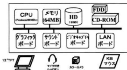
図1 信号処理システムブロック図
