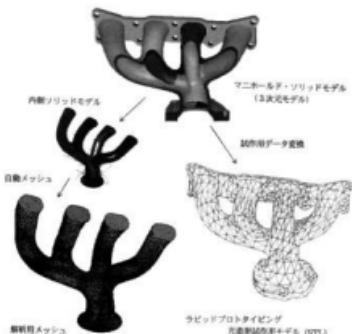
図2 3次元モデルから試作・解析モデルの作成
