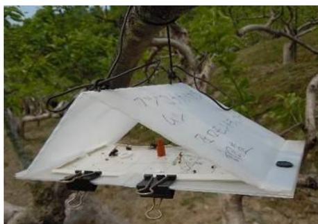
写真3 フェロモントラップ設置状況
