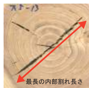
写真 内部割れ発生例（スギ）
