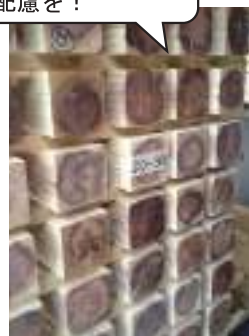
写真2 栈積みした材端部の様子
