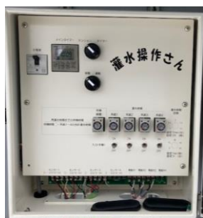
自動灌水制御装置 「灌水操作さん」
