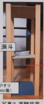
漏斗に定量の砂を入れ、砂を漏斗から落とした時に、実験装置下部に形成される砂山を観察した。落とす粒子は砂、砂鉄、米粉(うるち米)を用いた。
