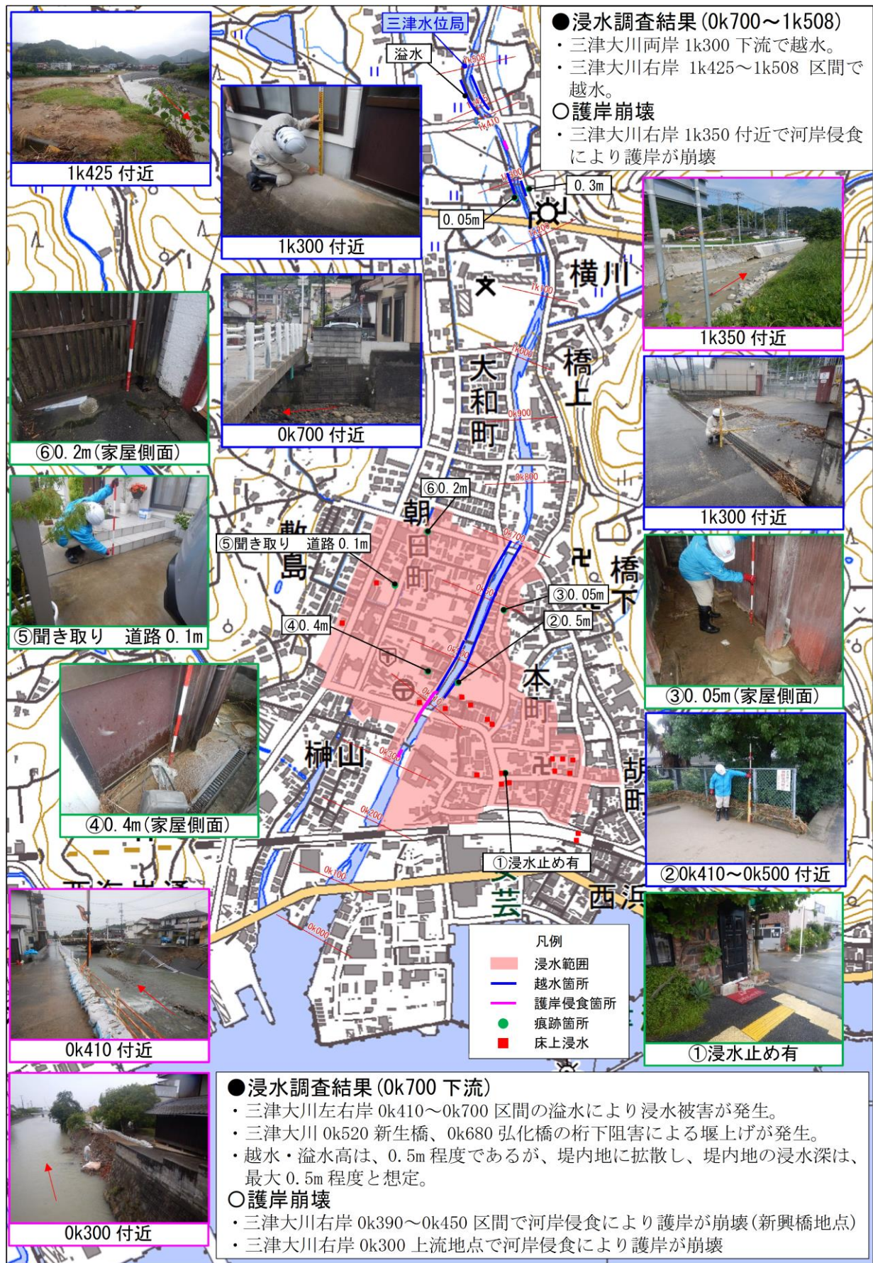
図-1.2.2(3) 三津大川水系の浸水被害実績図
